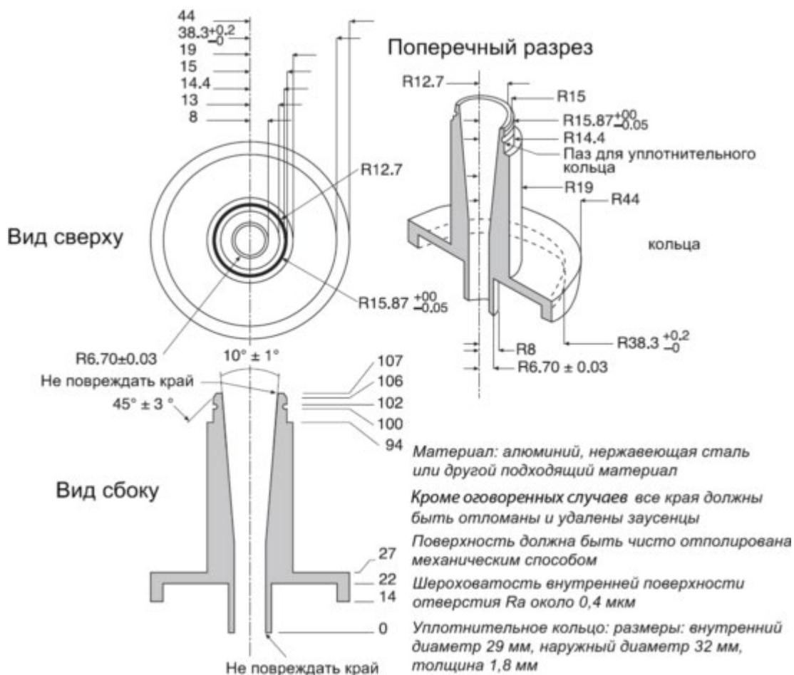
Рисунок 2.9.18.-10. Присоединение порта индукции к пре-сепаратору каскадного импактора Андерсена (размеры указаны в миллиметрах, если нет других указаний в частной статье)
