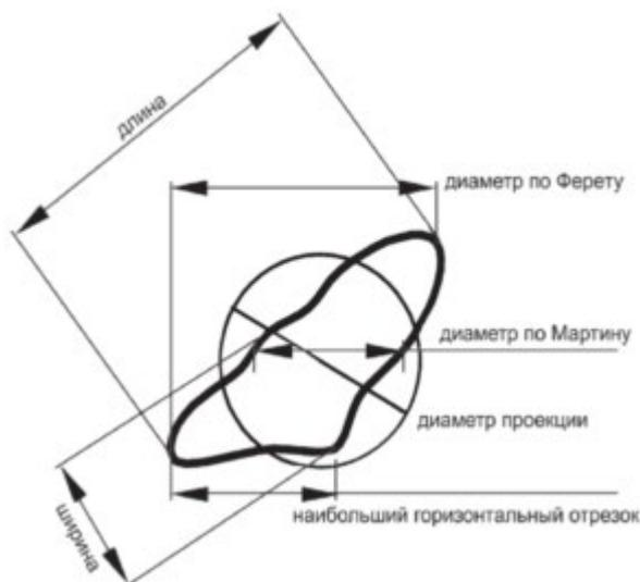
Рисунок 2.9.37.-1. Наиболее используемые способы измерения размеров частиц
