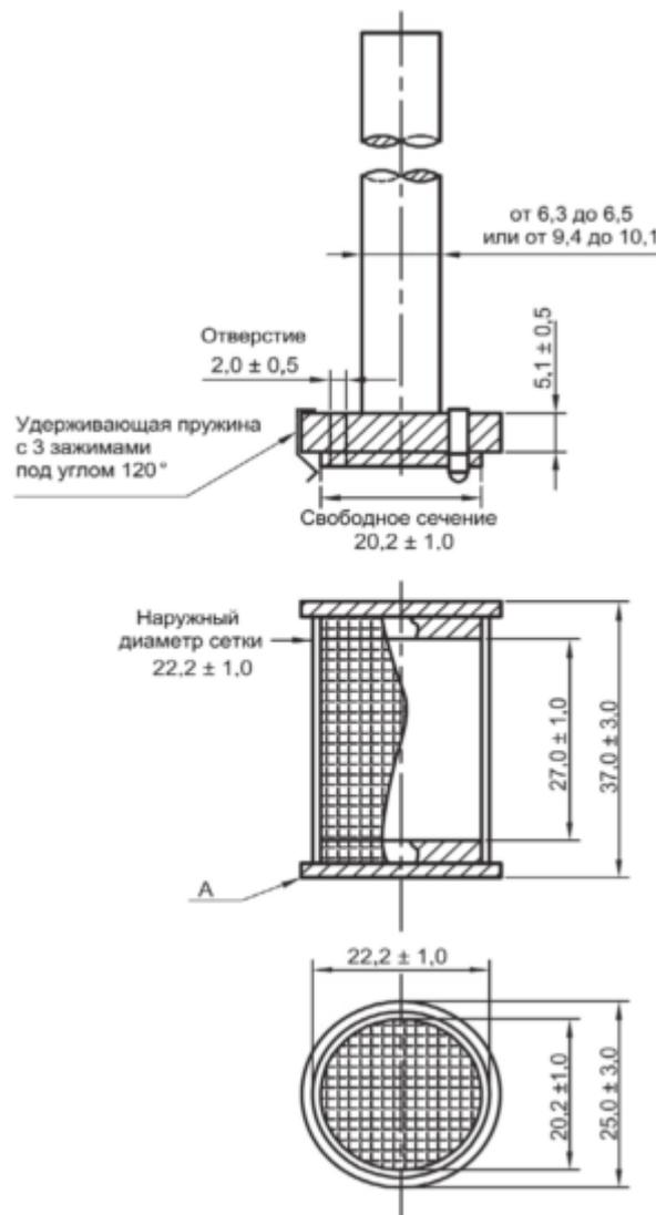
Рисунок 2.9.3.-1. *Прибор 1. Вращающаяся корзинка (размеры указаны в миллиметрах)*
